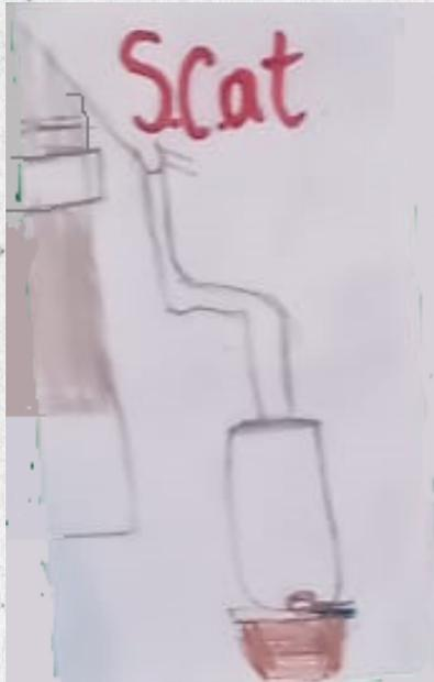
El SCAT es un sistema de captación de agua de techo, nos asegura una fuente de agua sustentable. El agua de lluvia es interceptada es interceptada, colectada y almacenada en un depósito para su futuro uso en nuestra huerta, o en la Ekococina.
